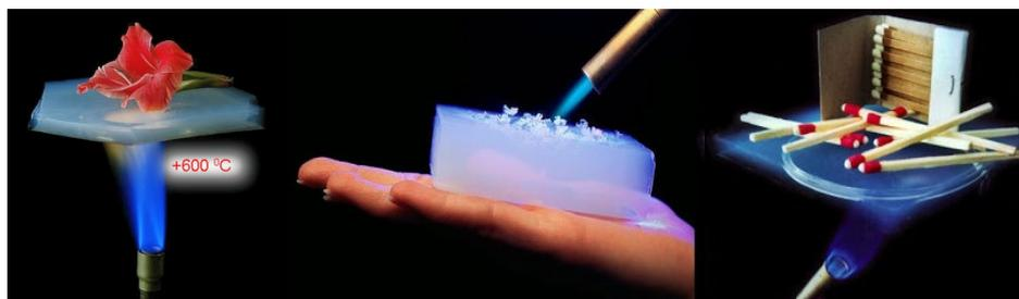
Рис. 1. Демонстрация изоляционных свойств аэрогеля
